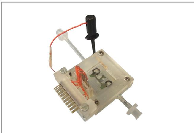
Halterung mit EWOD-Chip und Anschlüssen für die Ansteuerung. © Fraunhofer FIT | Bild in Farbe und Druckqualität: [www.fraunhofer.de/presse](http://www.fraunhofer.de/presse).
